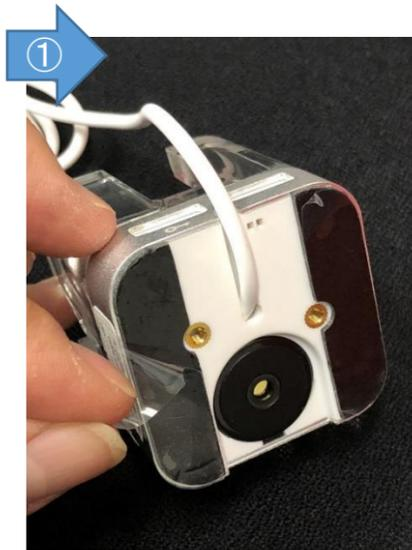
①設置位置の台面をよく拭き取り、JMAX本体底面シールの剥離紙を剥がして仕器に貼り付けます。
