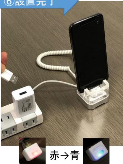
⑥電源コードのUSB端子をACアダプタと接続し、コンセントに挿すと、防犯システムが自動起動します(ピーと長鳴り1回)。
